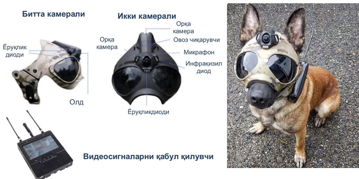
1-расм: Франция давлатида ишлаб чиқариладиган “K9 Vision system” видео кузатув тизими.
